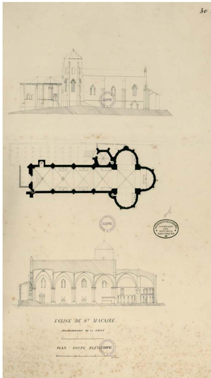
EGLISE : FACADE PRINCIPALE ET COUPE TRANSVERSALE ET ELEVATION FACADE PARTIE NORD ET COUPE LONGITUDINALE
