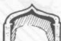
arc en accolade
